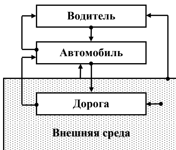
Рис. 2.1. Структурная схема системы эксплуатации автомобильной техники
